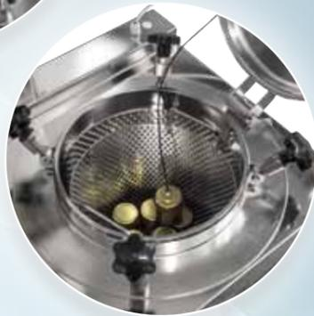
Sistema di sterilizzazione con cesto in acciaio inox
